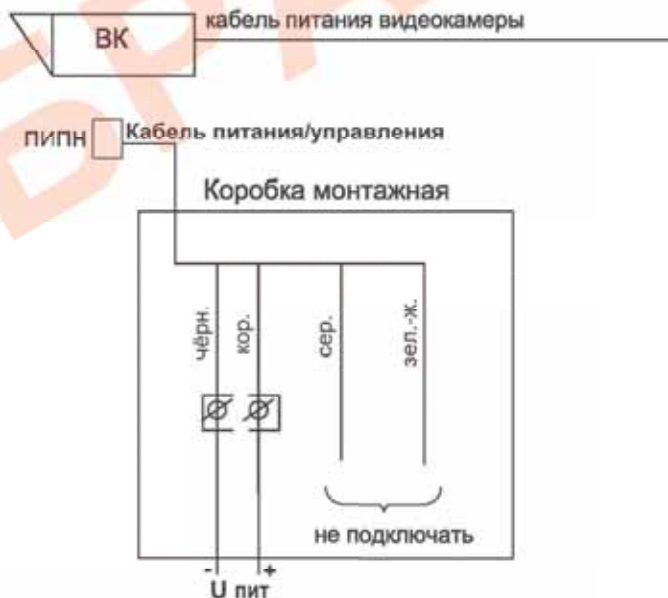
Рисунок 4 – Схемы подключения прожектора
