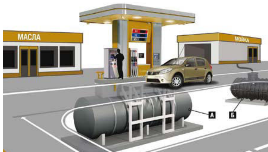
Металлические емкости А и Б — с антикоррозийным покрытием. Снаружи их покрывают полимерно-битумной мастикой. Объем танков (А) для хранения бензина и дизельного топлива — от 10 до 100 м 3 .
