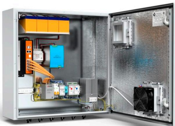
Всепогодный узел коммутации **ВУК-68-Р0Е+ Р2 В1 У11 У81** предназначен для обеспечения работы от 1-го до 8-и оконечных IP-устройств с питанием по технологии PoE (IEEE 802.3af/at/bt), организации группового канала передачи данных по волоконно-оптической сети, а также поддержания заданного температурного режима при эксплуатации задействованного оборудования.
