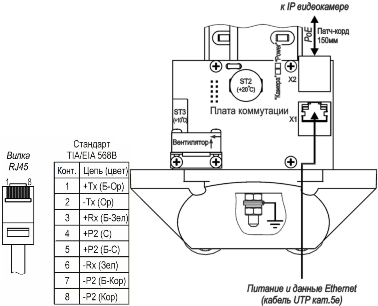
**Примеры подключения видеокамер с питанием PoE+:**
