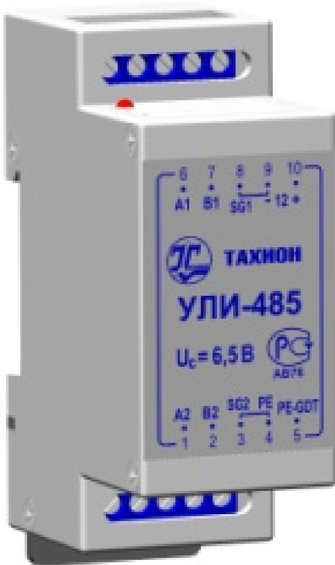
Удлинитель (повторитель) линий интерфейса **УЛИ-485** предназначен для увеличения дальности связи по сети RS-485, для защиты оборудования сети интерфейса RS-485 от импульсных перенапряжений (грозовых, электростатических разрядов и др.) в пределах 1÷2 зон молниезащиты и выше (в соответствии с МЭК 61312-1) и имеет гальваническую развязку.
