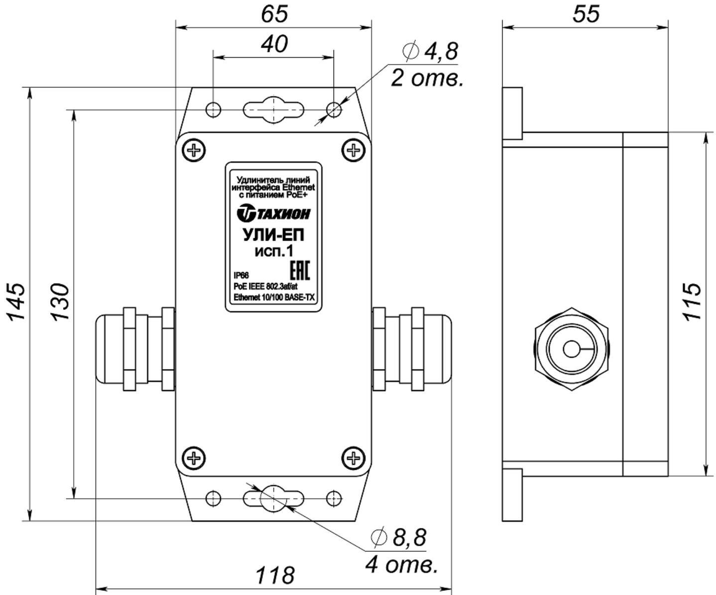
Рис.1 Внешний вид и габаритно-установочные размеры.
