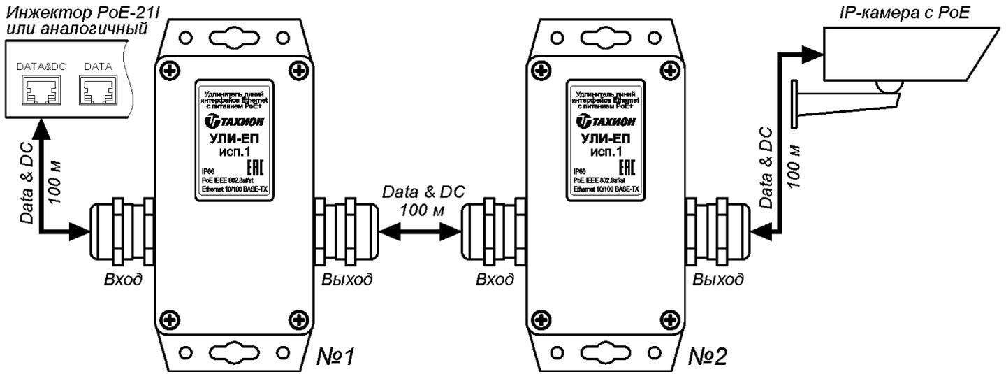
Рис.3 Пример удлинения сегмента сети Ethernet с питанием PoE
