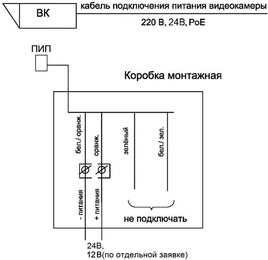
Схема подключения прожектора в режиме "включение/выключение ПИП от встроенного сенсора освещенности"
