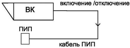
Включение/выключение режима "день/ночь" в видеокамере от сенсора освещенности ПИП
