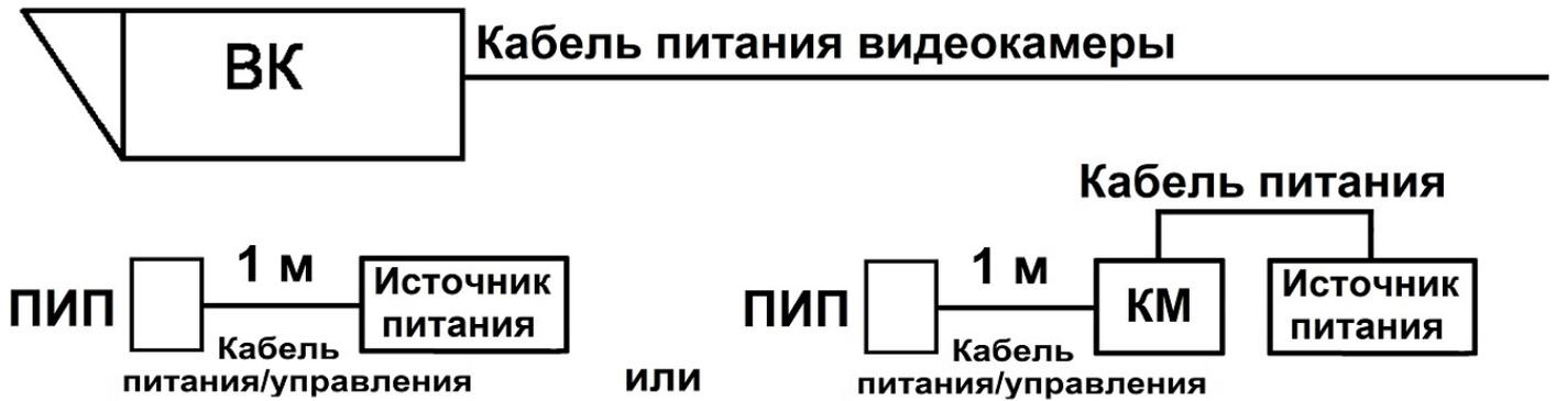
Питание от источника питания термокожуха видеокамеры, включение/выключение от реле видеокамеры или от встроенного датчика освещённости
