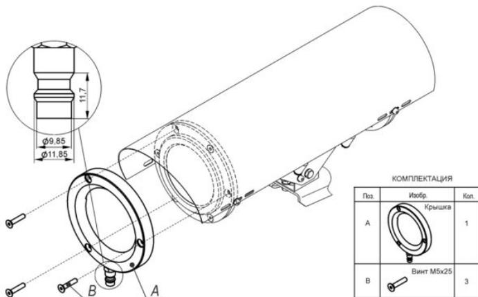
Насадка пневматическая НП-8 предназначена для предотвращения загрязнения смотрового стекла, за счет создания перед стеклом высокой скорости потока воздуха и избыточного давления.
