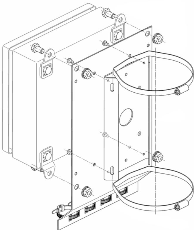
Кронштейн **КС-2** предназначен для крепления коробок монтажных КМ-4, КМ-5, КМ-6, блоков питания БПУ-1 и БПГ-75Вт на квадратные и круглые опоры  $90 \div 106$  мм,  $\varnothing = 115 \div 135$  мм (другой размер - под заказ) и крепления (фиксации) подводящих кабелей или металлорукавов.
