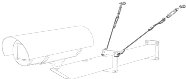
Комплект растяжек предназначен для установки кронштейнов КТ-400, КТ-600, КТУ-250, КТУ-400, КТУ-600 с переходниками кронштейна ПК-200, ПК-400, ПК-600, ПК-800, ПК-1000 на стену.
