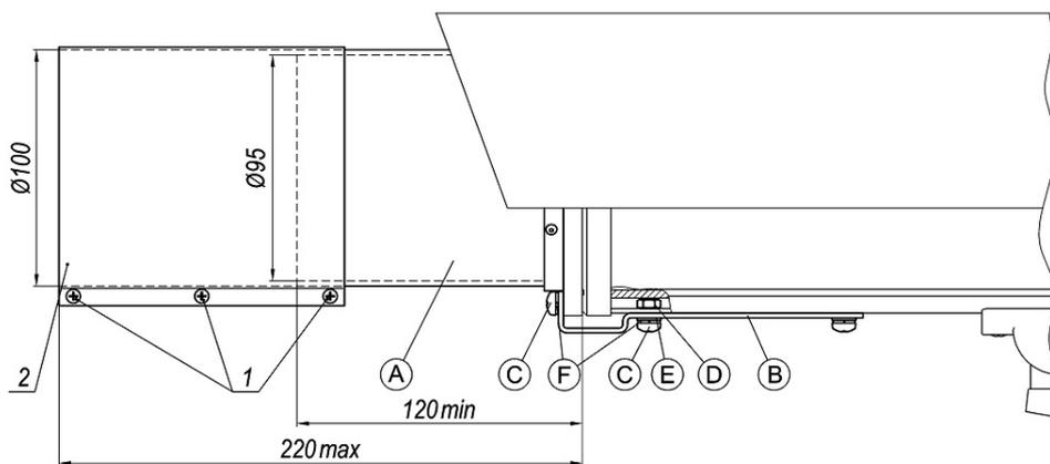
Рис.1 Установка бленды защитной на видеокамеры в гермооборотах ТГБ-4Г Ex, ТГБ-4Р Ex
