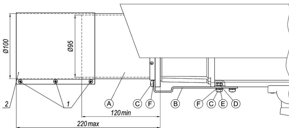
Рис.2 Установка бленды защитной на видеокамеры в гермооборотах ТГБ-7, ТГБ-7Р, ТГБ-7У
