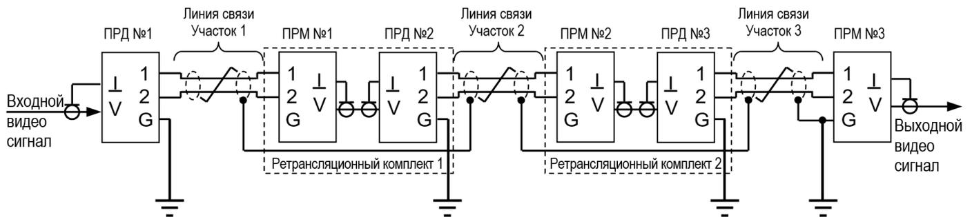
**Схема построения линии с Мах длиной 2100м при невозможности заземления на всех передающих сторонах**
