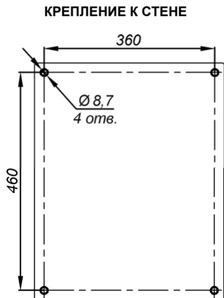
Отверстия для крепления к стене предусмотрены на задней стенке термощкафа.
